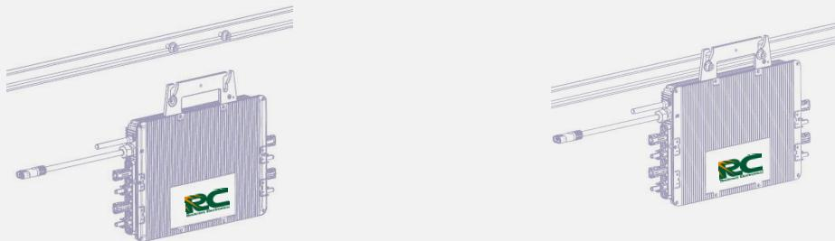
交流电缆中含有地线，可直接接地。
