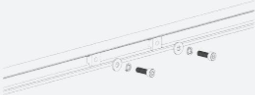
③ 将微型逆变器挂在螺丝上，然后拧紧螺丝。
