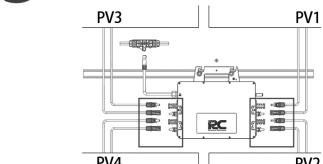
Stellen Sie sicher, dass das PV+ und PV- des gleichen PV-Kanals dem gleichen PV-Modul entspricht, da sonst der Wechselrichter beschädigt werden kann.
