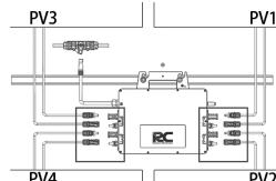
Assicurarsi che il PVn+ e il PVn- dello stesso canale PV corrispondano allo stesso pannello fotovoltaico, altrimenti si potrebbe danneggiare l'inverter.
