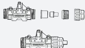
在交流干线电缆的另一侧安装交流末端电缆（连接到配电箱）。
