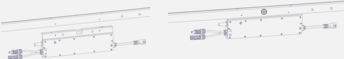
交流电缆中含有地线，可直接接地。
