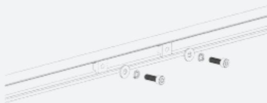
③ 将微型逆变器挂在螺丝上，然后拧紧螺丝。
