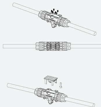
在交流干线电缆的另一侧安装交流末端电缆（连接到配电箱）。
